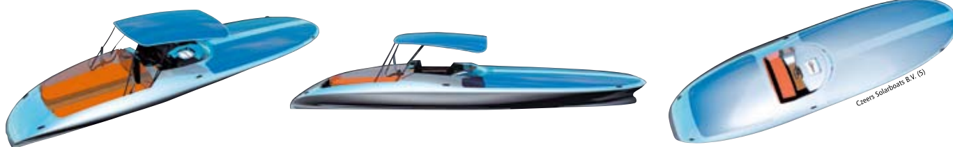
Impresiones de la Czeers: con el bimini (toldo) abierto, el barco ofrece espacio para cinco personas. Gracias al casco de fibra de carbono y a otras medidas de ahorro de peso, sólo marca 900 kilos en la báscula.
