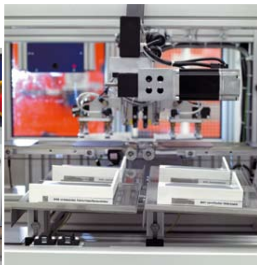
En Sunways se comprueba primero la calidad de las obleas: las buenas van directas a producción, las menos buenas se mejoran y las malas se desechan.
