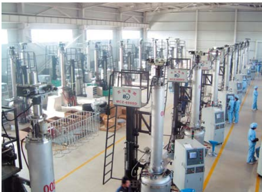
La nave de producción de Xi'an Longi en la provincia china de Shandong: mediante el «método magnético de Czochralski», la empresa obtiene obleas con un contenido muy bajo de oxígeno.
