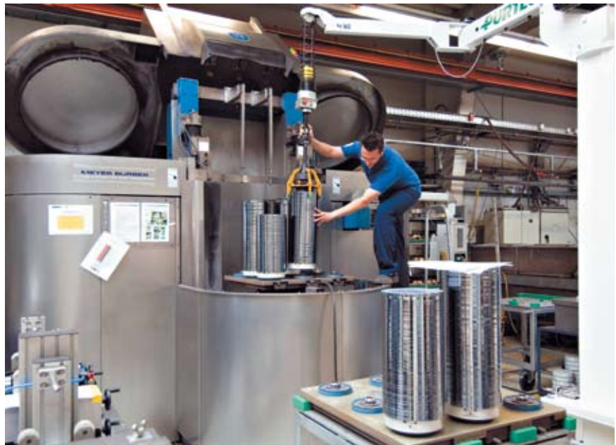
Montaje de los lingotes en la sierra (Ersol Wafers): aquí se puede distinguir entre material de alta y de baja resistividad. El silicio de alta resistividad es más duro.
