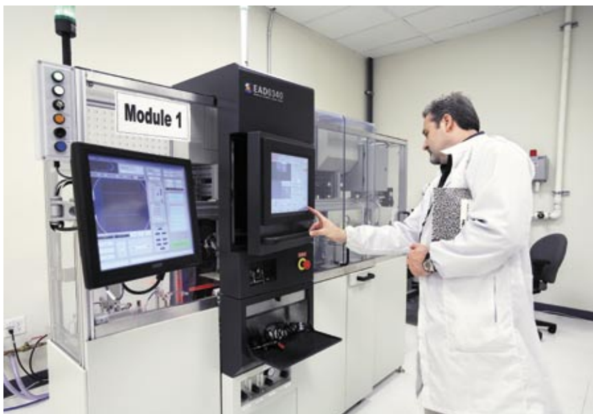
Dos a partir de una: Chris Miah, empleado de Solaria, maneja una sierra de obleas que divide una célula de cinco pulgadas en 60 tiras finas, 30 de las cuales serán procesadas para obtener una célula de concentración.
