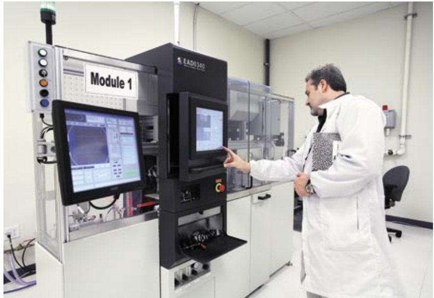
Dos a partir de una: Chris Miah, empleado de Solaria, maneja una sierra de obleas que divide una célula de cinco pulgadas en 60 tiras finas, 30 de las cuales serán procesadas para obtener una célula de concentración.
