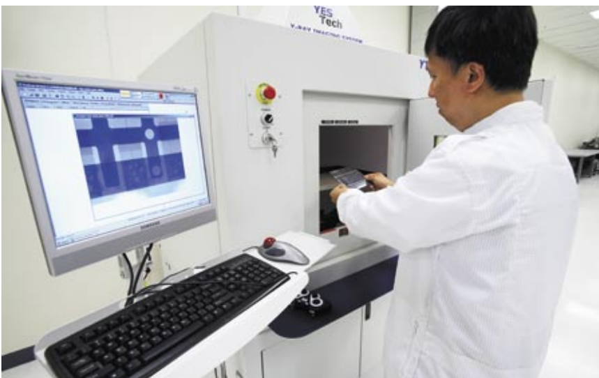
Preparativos para la certificación según UL e IEC: Solaria comprueba la calidad de las células así como su durabilidad y potencia. Aquí, Neelson Co está insertando una célula en un aparato de rayos X.
